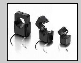
Les transformateurs ouvrants type « Tio » ont été conçu pour permettre une surveillance peu couteuse des circuit électriques. La charnière unique et mousqueton de blocage permettent d'instrumenter un circuit sans interrompre le courant primaire. Leur conception autorise des niveaux de sortie allant jusqu'à 10V alternatif ou continu sans amplification. L'excellente linéarité permet la mesure de courants inférieurs à 10 mA
